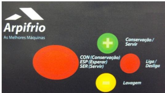
O teclado da máquina tem três teclas e um visor. Com o acionamento de uma tecla ou conjunto de teclas pode entrar nas várias funções da máquina.
